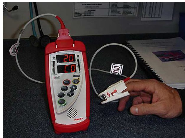
Figura 1 Medición por pulscioximetría de una carboxihemoglobina del 20% en un intoxicado por humo.
